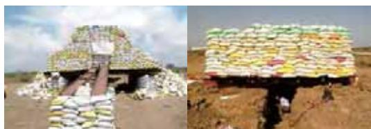
圖二十一 樁載重試驗(左)與平鉗載重試驗(右)
