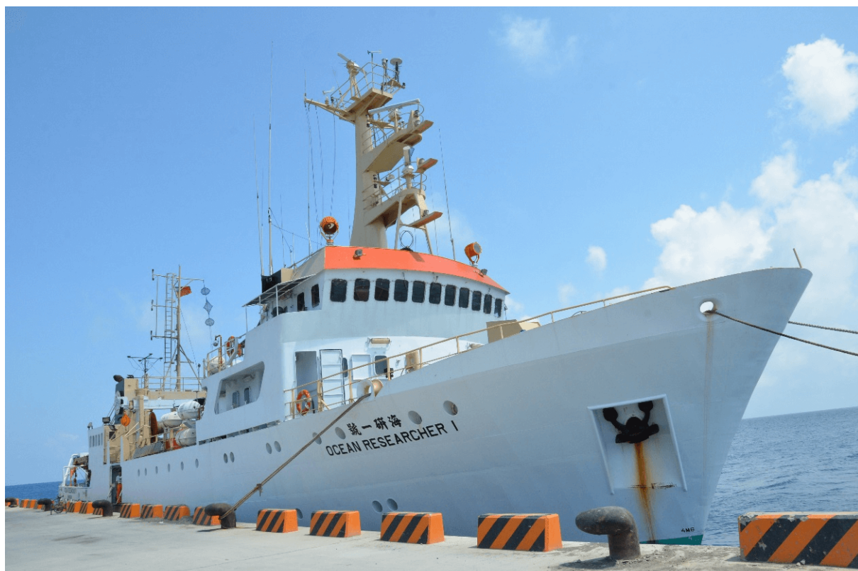
C6 GR海研一號測量船全長約50公尺；寬約10公尺。原為國科會出資建造，臺灣大學海洋研究所負責營運管理之海洋研究船，退役後由環球測繪購入，斥資數千萬元改裝為地球物理調查船，投入台灣離岸風力相關地物探查作業
