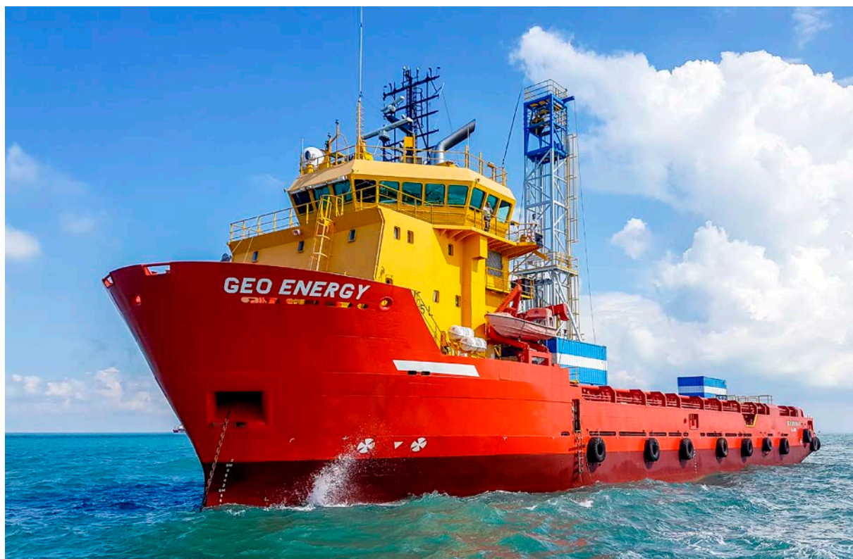
C5 GE大地能源號 (MV Geo Energy) 全長72.2公尺，船寬16公尺，具有DP-2動態定位系統，為國內首艘海上鑽探船。於2017年由環球測繪公司改裝為鑽探船後引入國內市場，最大鑽探深度超過水下千米
