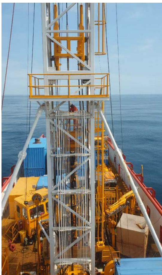
C3 GE下孔式CPT施作 CPT鑽塔上具有垂直補償(Heave Compensation)系統，可在波浪起伏下保持鑽桿之穩定性
