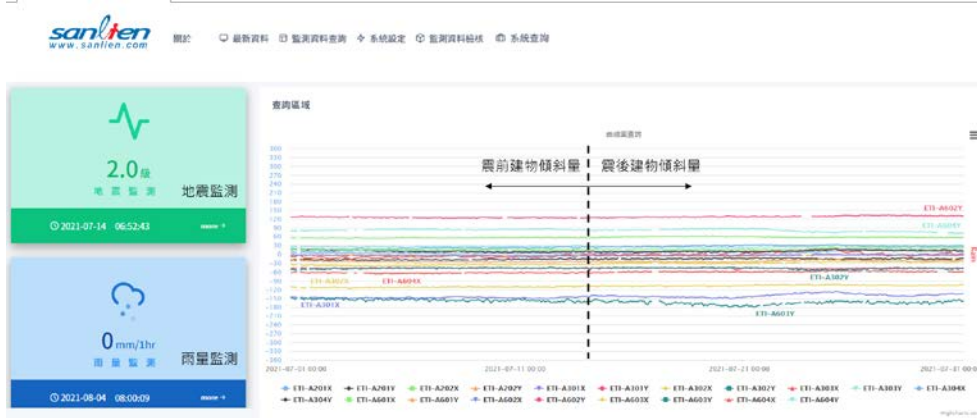
圖五 地震發生前後，結構傾斜監測變化曲線圖
