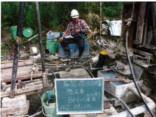
圖五 蘇花改滲漏試驗
