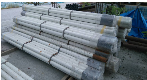
圖八 新自強隧道所採用之玻璃纖維灌漿管
