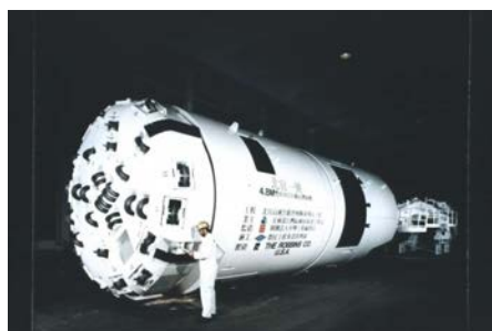
投影片 12 導坑TBM(Robbins)直徑4.8M
