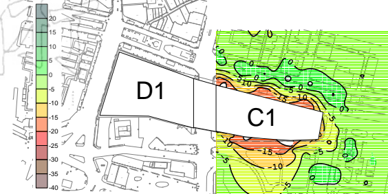
圖十九 C1區連續壁施工完地表沉陷分布(mm)
